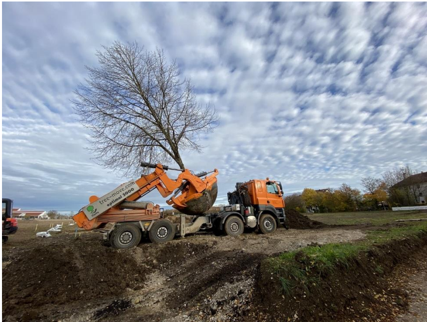
Eine Linde zieht um: Im Rahmen der Großbaumverpflanzungen im November 2020 fanden insgesamt 18 Bäume auf dem Gelände der Landesgartenschau ein neues Zuhause. Die Linde ist einer der Bäume, der in der Sphäre „Wiese“ mehr als sechs Monate lang mit einem Sensor von „Treesense“ ausgestattet war. Foto: Kirchheim 2024 GmbH/Sophia Schreib
